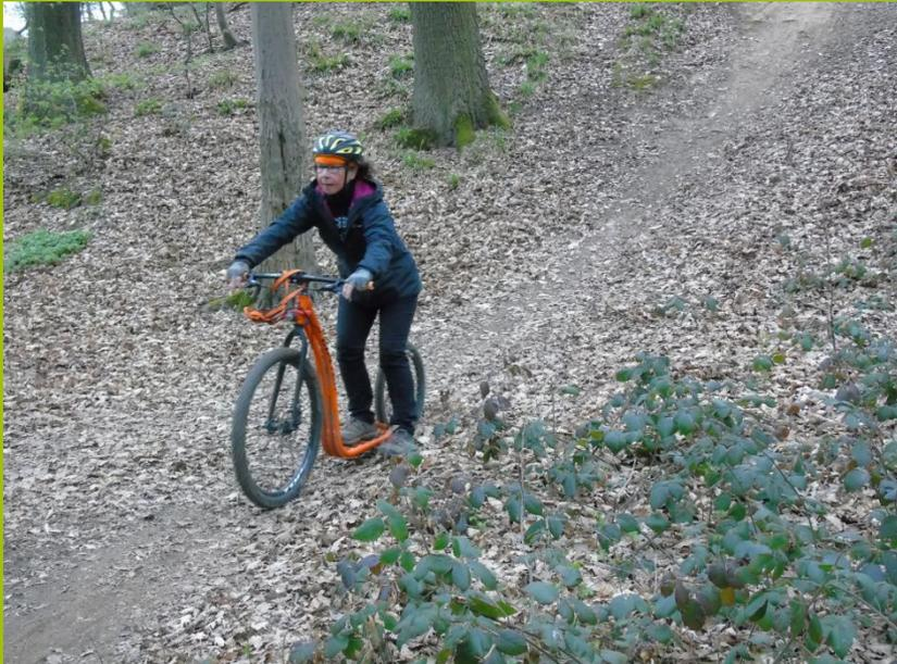
2 Finger an der Bremse, beide Bremsen – Vorder- und Hinterradbremse gleichzeitig betätigen.
